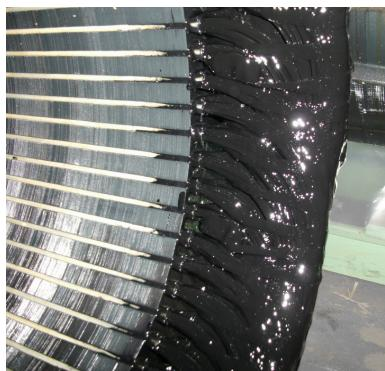
黑色複合漆固化後形成堅韌，有彈性，有光澤的黑色厚塗層，密封銅琺瑯對抗濕氣和化學成份腐蝕。因為此漆的包覆能力及彈性，可發揮阻擋汙染粒子及吸收撞擊的功用。更佳的是，高度彈性的漆質可延長保護壽命，隨著繞組由冷到熱的情況複合物質成份在熱脹冷縮循環下不會造成任何裂縫產生。
